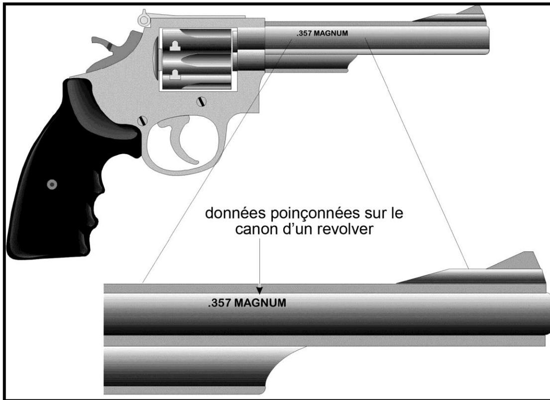
Figure 93. Exemple d'un poinçon de canon
